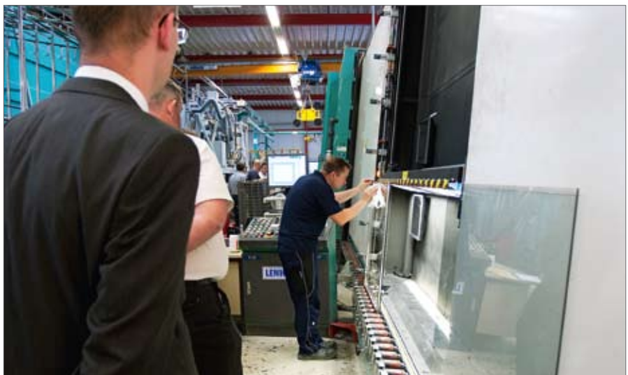
Unterstützt vom Viprotron Quality Scanners kann der Mitarbeiter bei Auffälligkeiten in Sekunden über das weitere Vorgehen entscheiden.
