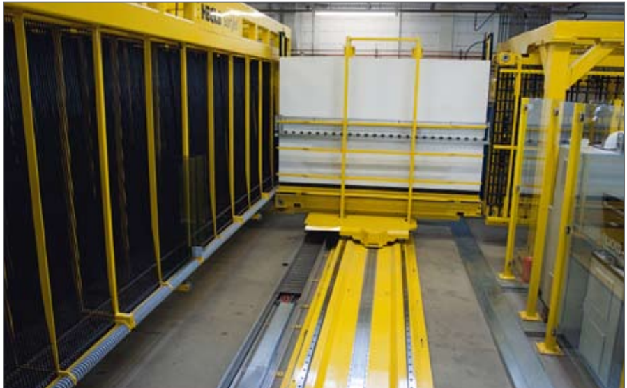
Der Input-Shuttle in Aktion. Am Boden erkennt man die elektromagnetischen Linearantriebe.
