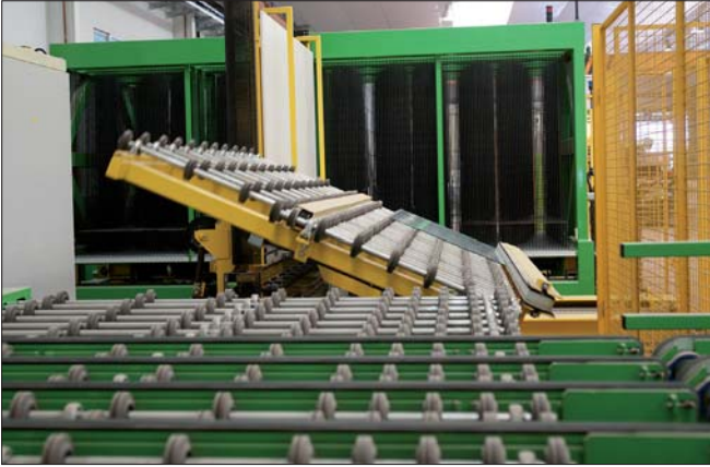
Die Zuschnitte werden von einem Kipptisch in die Vertikale gebracht und anschließend in den SortJet eintransportiert.
