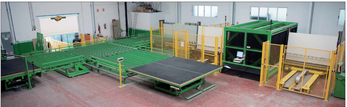
Von der Brechstation (ganz links) werden die Zuschnitte über einen Ecktransport und eine Aufstellvorrichtung dem SortJet zugeführt; dieser Dynamische Puffer beschickt die Isolierglaslinie in Produktionsreihenfolge, wie von der Pack-/Transportoptimierung errechnet. Scheiben in Übergröße werden im Brechbereich ausgeschleust und manuell zugeführt.
