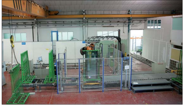
Automatische Zuführung leerer Transportgestelle zum Roboter per Hallenkran und Rollentransport
