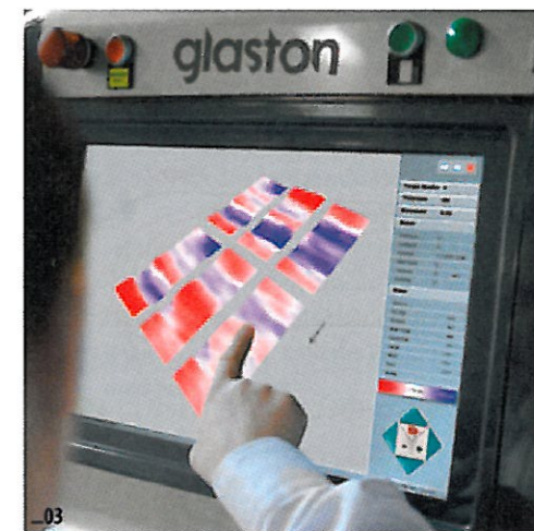
03 Maschine und Software ergänzen sich Fehler bei der ESG-Produktion meldet der iLook-Scanner direkt ins System zurück: Die Qualität der vorgespannten Scheiben ist so gesichert, der Veredelungsprozess wird beschleunigt und optimiert.
