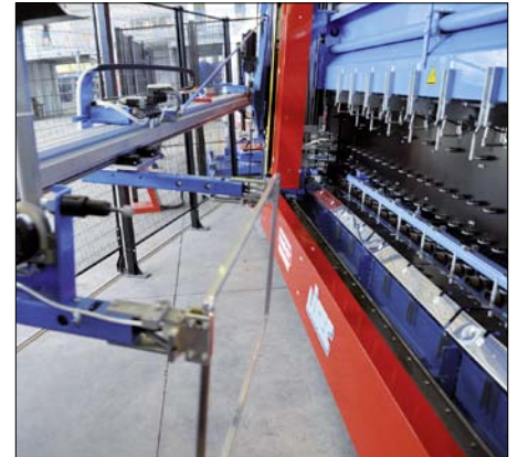
Die automatische Rahmensetzstation an der LISEC Hochleistungs-Isolierglaslinie. Alle Module der Linie kommunizieren mit Hilfe von ALBAT+WIRSAM-Software mit dem Zuschnitt, damit auf jede Änderung in der Produktionssequenz unmittelbar reagiert werden kann.
