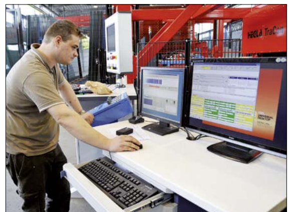
Links: Immer geradeaus! Die HEGLA Traveren-Drehvorrichtung TraCon kommt bei Glas Fandel erstmals zum Einsatz. Die platzsparende Neuentwicklung macht den 90° Richtungswechsel der Transportstrecke zwischen X- und Y Brechen überflüssig. Rechts: Der Zuschnitt-Leitstand visualisiert mit verschiedenen Anzeigetools die aktuelle Produktionssituation und erlaubt direkte Eingriffe in die Fertigungssequenz.
