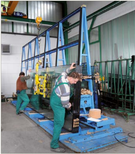
Großscheiben für das Projekt Flughafen BBI Berlin Brandenburg International. HoffmannGlas produziert Sanco-Isolierglas bis zu einer Größe von 3,21 x 6 m. Die dazu notwendige Verpackungs- und Transportlogistik ist anspruchsvoll und verlangt hohes Know-how.
