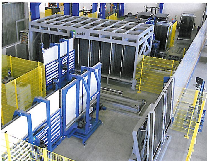
Système de tri Hegla géré par le logiciel Albat+Wirsam dans l'atelier de production de vitrage isolant de la société C. Bergmann, Linz
