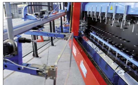
La station de cadrage automatique sur la ligne de vitrage isolant de haute performance LISEC. Tous les modules de la ligne communiquent avec la découpe à l'aide du logiciel ALBAT+WIRSAM afin qu'une réaction à toute modification soit immédiatement possible dans la séquence de production.
