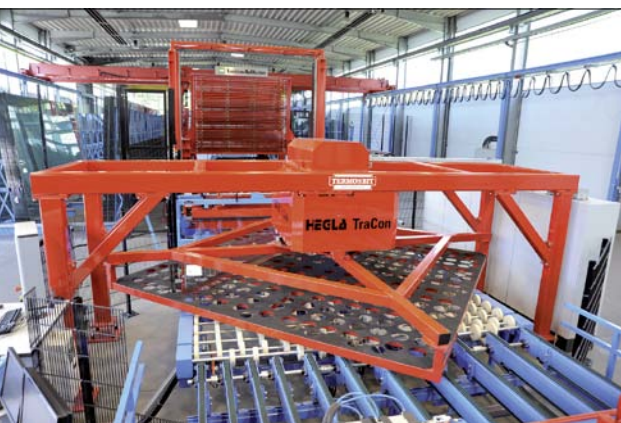
À gauche : toujours tout droit ! Le tourneur de travers TraCon de l'entreprise HEGLA est utilisé pour la première fois par Glas Fandel. L'innovation peu encombrante rend inutile le changement de direction de 90° des parcours de transport entre les casses X et Y. À droite : le poste de contrôle de la découpe visualise avec différents outils d'affichage la situation actuelle de la production et permet les interventions directes dans la séquence de fabrication.
