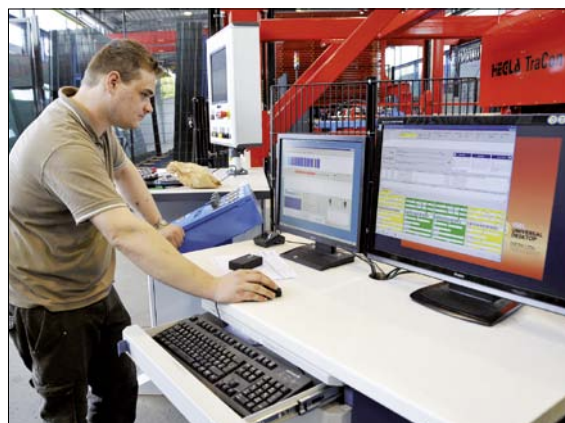
À gauche : toujours tout droit ! Le tourneur de travers TraCon de l'entreprise HEGLA est utilisé pour la première fois par Glas Fandel. L'innovation peu encombrante rend inutile le changement de direction de 90° des parcours de transport entre les casses X et Y. À droite : le poste de contrôle de la découpe visualise avec différents outils d'affichage la situation actuelle de la production et permet les interventions directes dans la séquence de fabrication.
