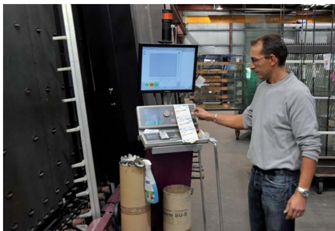
A gauche : une étiquette du client est apposée sur chaque produit afin d'identifier et d'affecter précisément les verres. L'impression des étiquettes est lancée après la création du lot dans le système de planification de la production ALCIM
