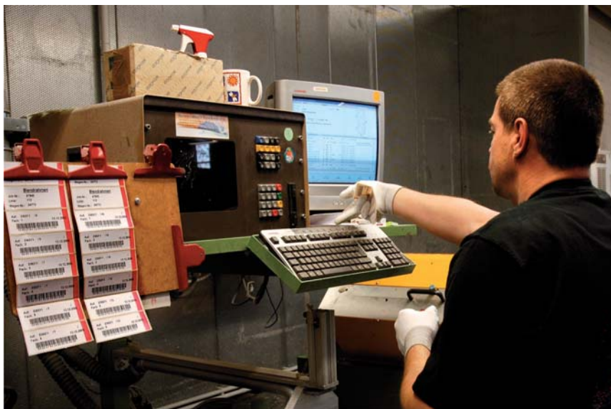
Mit Hilfe eines konsequent ausgebauten Barcodesystems werden alle notwendigen Informationen, etwa über Status, vorzunehmende Bearbeitungen etc., aus der zentralen Datenbank abgerufen und an den Arbeitsplatzmonitoren angezeigt. Etiketten können direkt vor Ort gedruckt werden und müssen nicht aus entlegenen Büros zu den Arbeitsstationen getragen werden.
